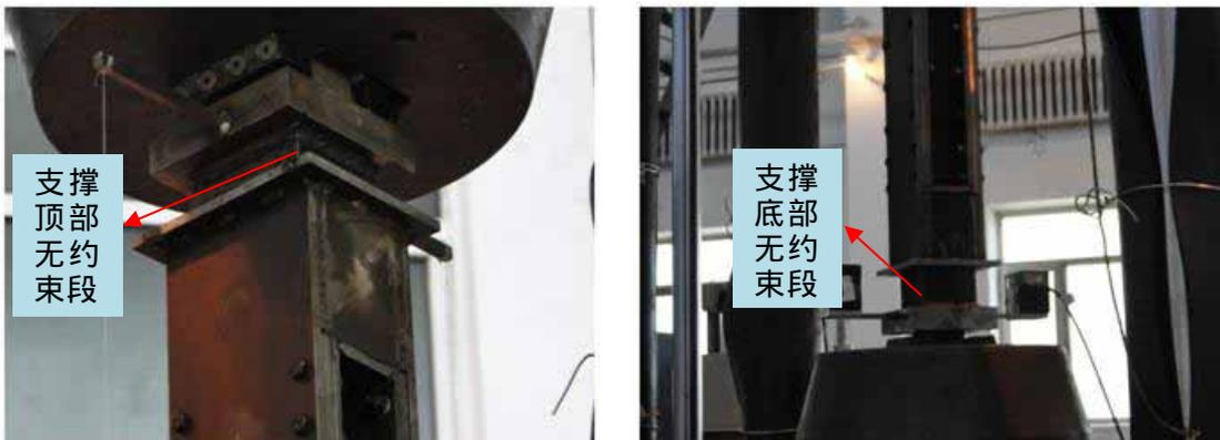
图 3-20 支撑端部无约束段示意图
