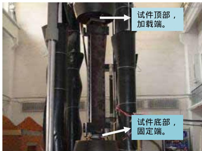
图 3-2 试件 HBRB1 试验装置
