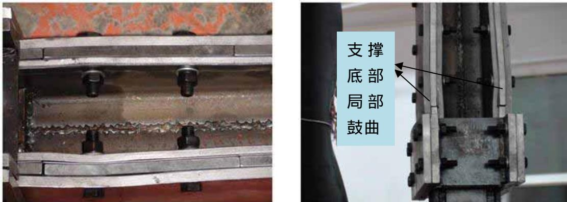
图3-7 试件HBRB1底部局部鼓曲破坏
