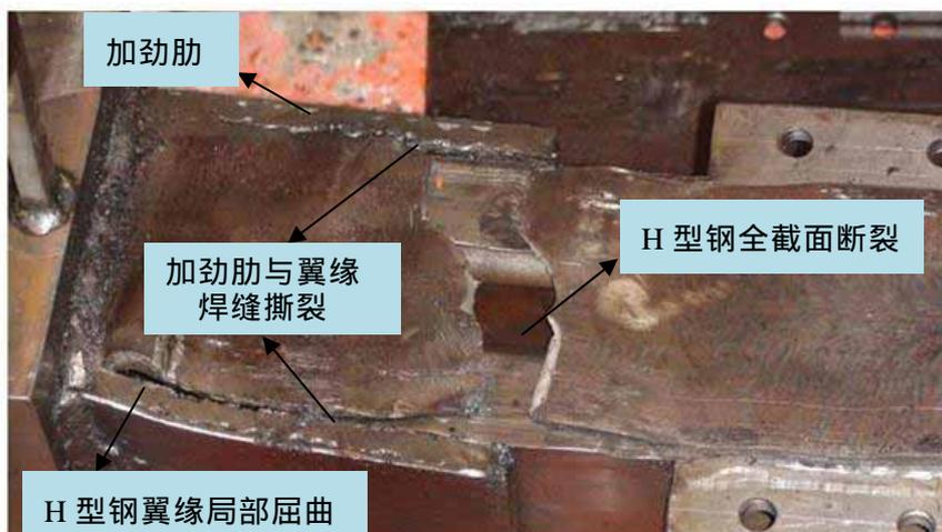
图 3-17 HBRB2 内芯底部断裂
