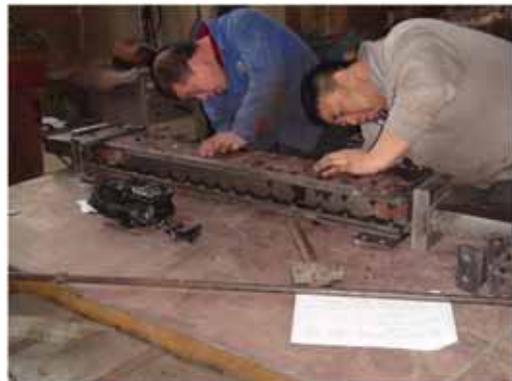
图2-17 试件HBRB1约束构件组装图
