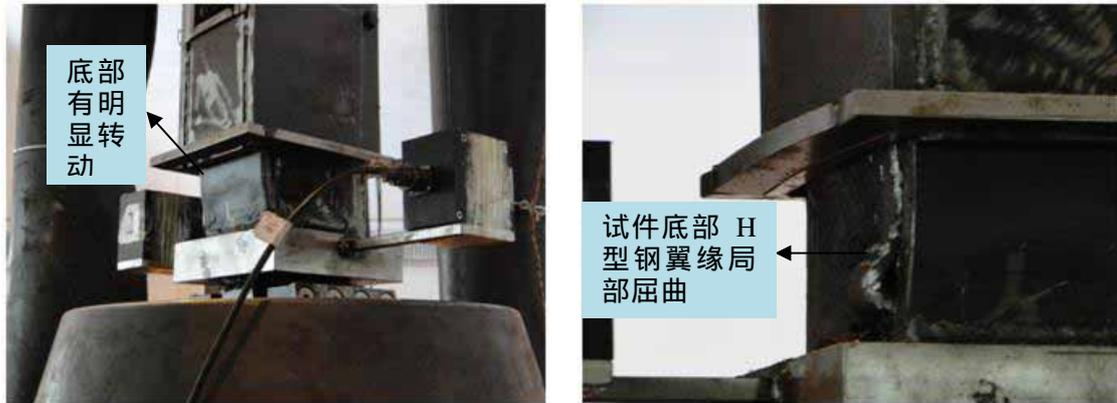
图 3-16 HBRB2 底部破坏
