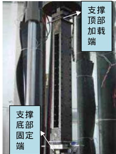
图 3-11 试件 HBRB2 试验装置
