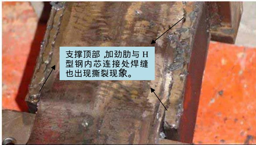
图 3-18 HBRB2 内芯顶部破坏
