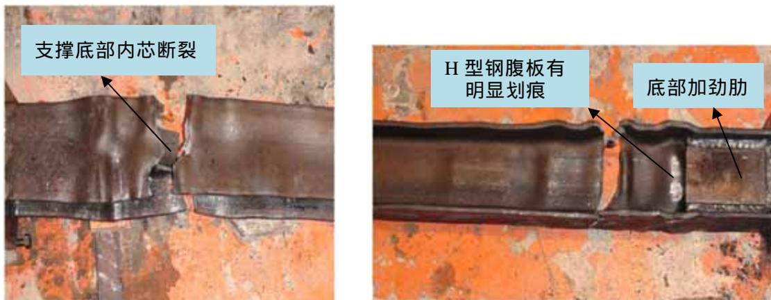
图3-8 试件HBRB1内芯断裂
