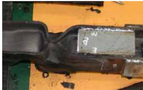
图 1-10 H 型钢防屈曲支撑局部屈曲
