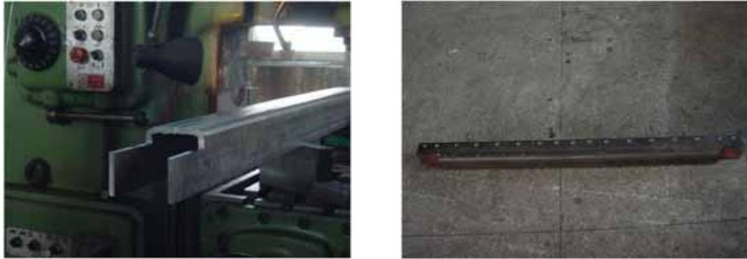
图2-15 试件HBRB1U型槽钢端部加工图
